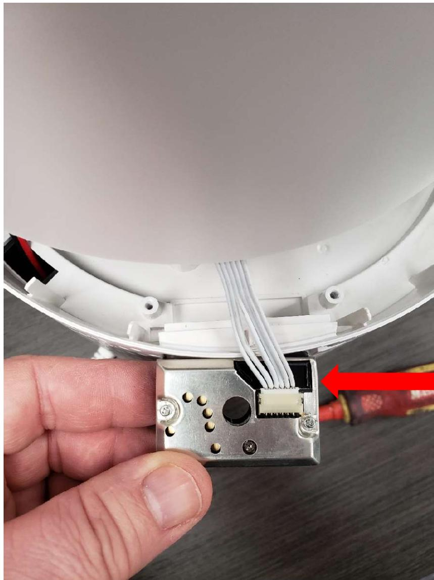
Débrancher le sensor et le remplacer, il suffit de suivre les étapes inverses pour remonter.
