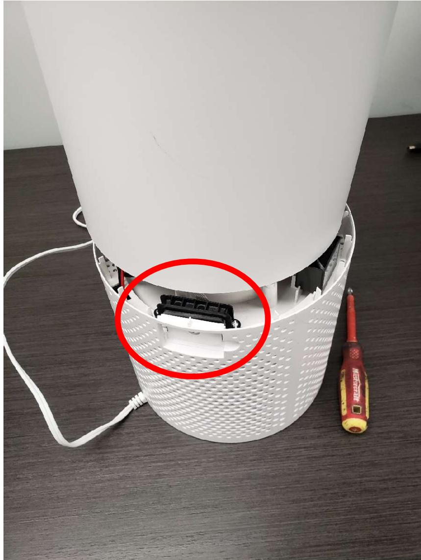
Retourner à nouveau l'appareil, et décaler la partie supérieure
